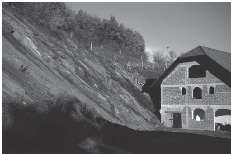
Slika 4. Temno sivi do sivkasto črni, plastnati in ploščasti laporovci in glinavci dvanajste litostratigrafske enote.
